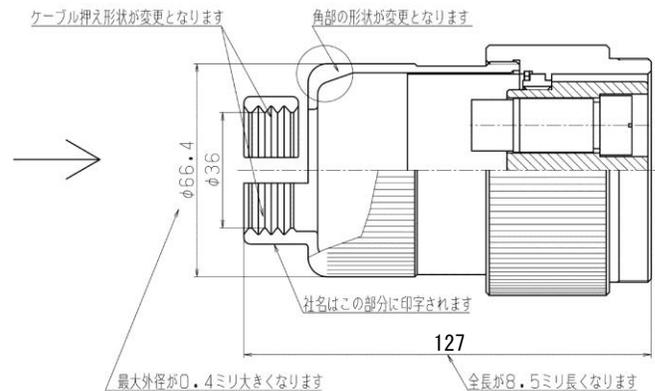
中継プラグ、クランプサドルの材質を黄銅から亜鉛合金に変更します。
