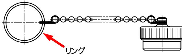
取り付けは、結線作業時のケーブルを通す際に、このリングを下図の様に通します。
