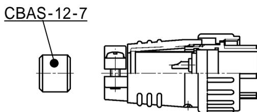
CB (ケーブルブッシング) は結線作業時のケーブルを通す際に、あらかじめ下図の様に通しておきます。
