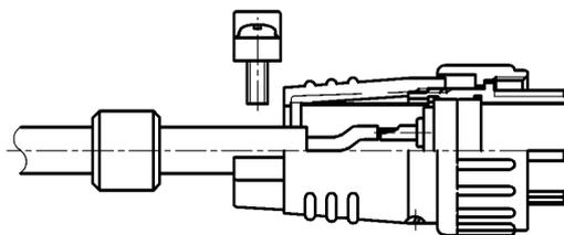
CB (ケーブルブッシング) を下図の位置に移動後、クランプサドルで挟みクランプねじを締め付けます。
